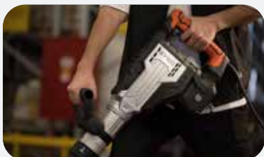
מערכת בולמי זעזועים קדמית - מפחיתה רעידות ועומס על הידיים
