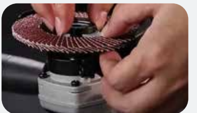
החלפת דיסק בצורה נוחה, בטוחה ומהירה, הודות לתפס נעילת הגיר
